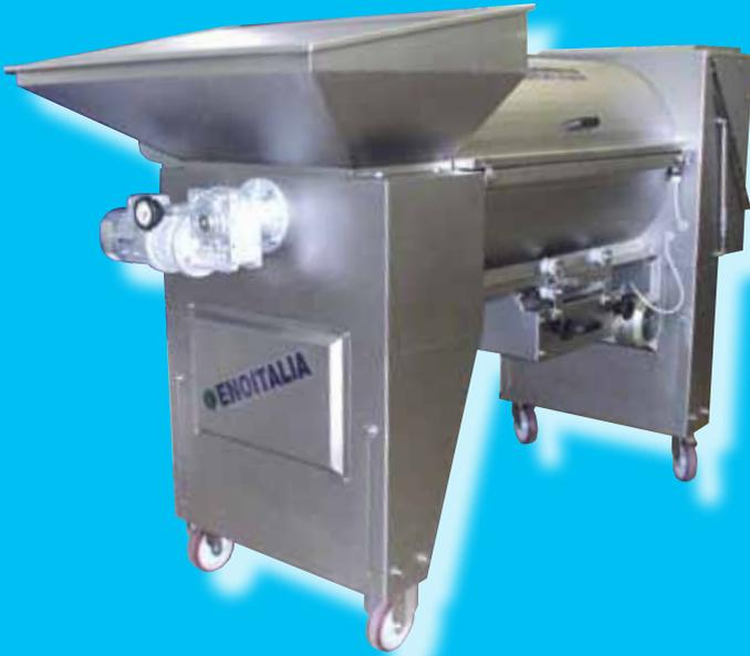
**RICEVIMENTO UVA:** la tramoggia di carico è dotata di motorizzatore indipendente per regolare la velocità di carico. Di serie è installato un filtro per l'estrazione del liquido ed un raccordo per collegamento di pompa esterna. La coclea di trascinamento è costruita con profilo circolare arrotondato. Le gambe telescopiche installate di serie, consentono di adattare Jolly Reverse a qualsiasi tipologia di linea di ricezione e selezione uve.
